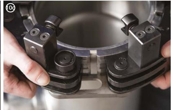
Die zerlegte Schlinge wird auf den Fitting aufgesetzt. Die Schlinge verfügt über eine spezielle Rille, in welche der Flansch des Fittings eingepresst werden muss. Nach der korrekten Befestigung der Schlinge am Fitting soll die Schlinge durch erneutes Eindrücken des Bolzens und Schließen des Verbindungsstücks gesichert werden.
